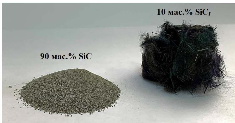
Рисунок 57 – Объемное отношение исходных компонентов для создания композита SiC/SiC f с 10 мас.% волокон SiC
