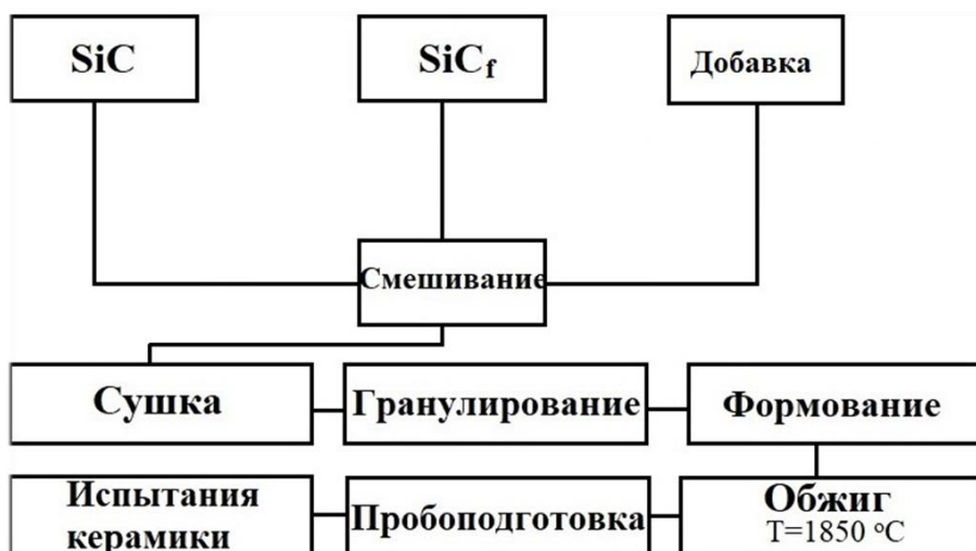
Рисунок 56 – Технологическая схема получения композита SiC/SiC f
